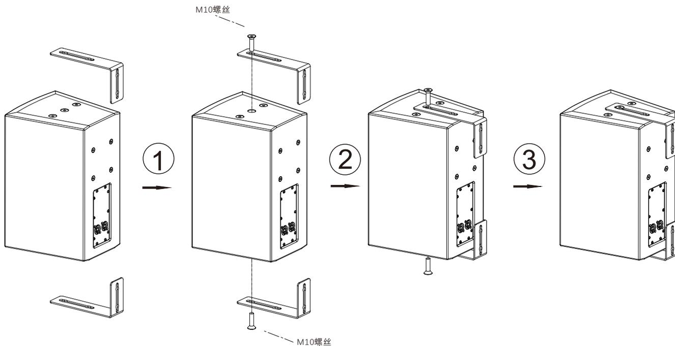
2b) 用箱体提供的六角沉头机丝螺丝将扬声器固定在墙体上，如同所示。
