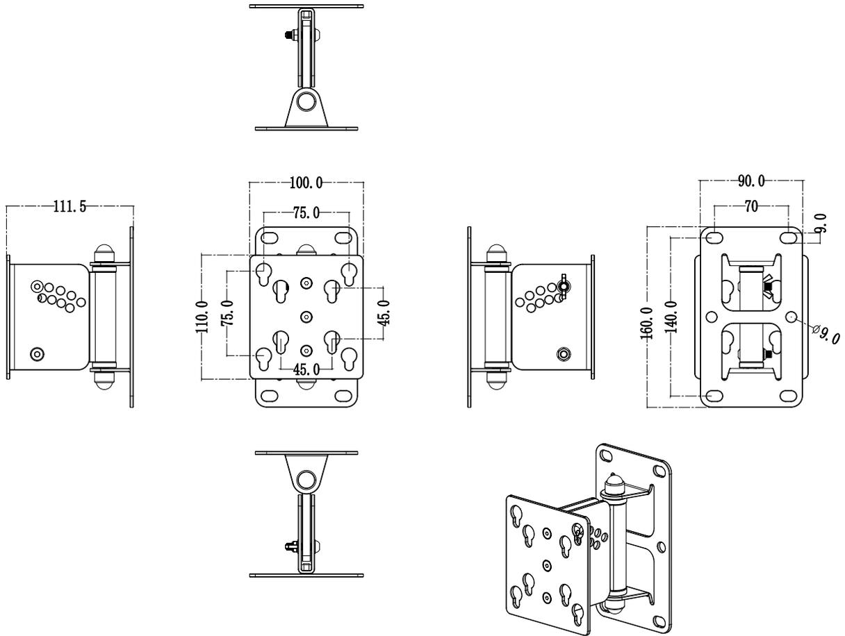
6) 设置倾斜角-扬声器跟T8支架连接在一起的时候，将支架的M6螺丝拧松，对应支架上合适的角度位置孔，将螺丝插进对应角度孔内，并拧紧螺丝。
